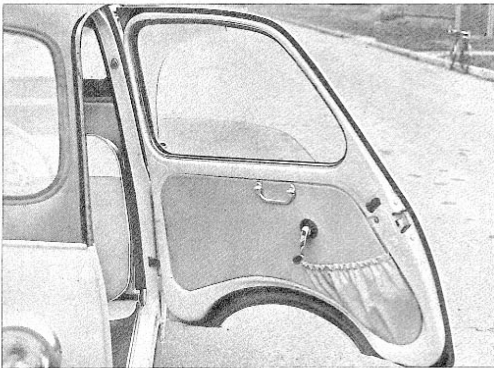
L'interno della portiera anteriore sinistra: il cristallo è abbassato al massimo. La tasca è solo in questa portiera.
