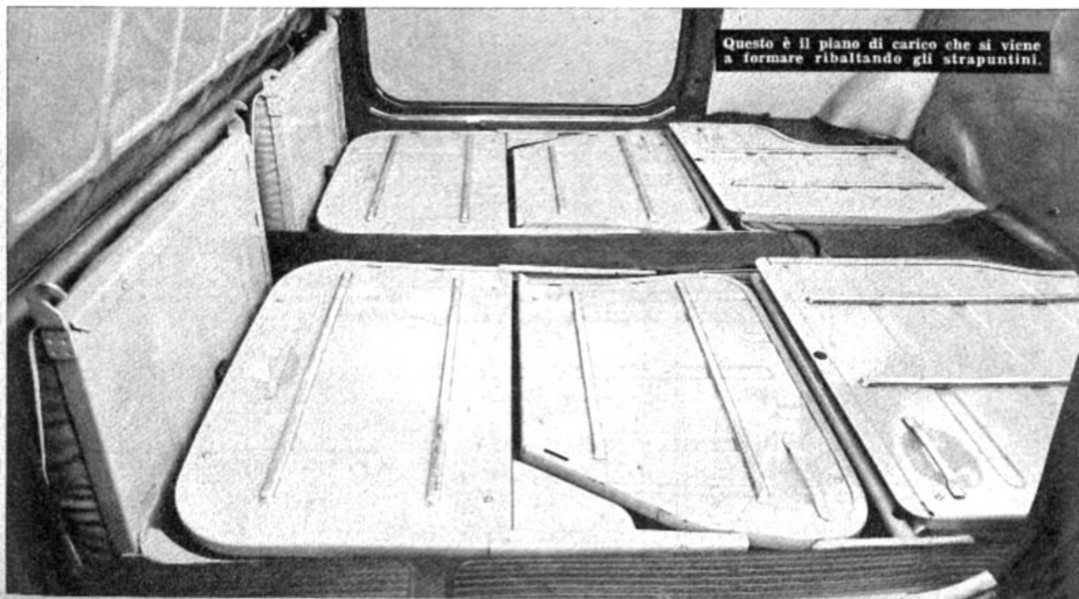
I quattro strapuntini montati sulla «Multipla» versione «6» posti.
