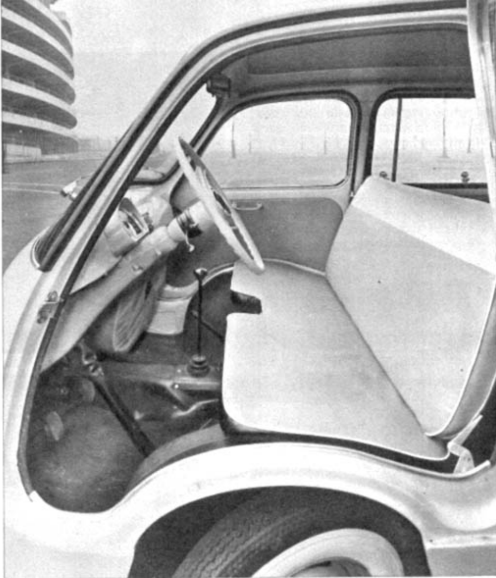
I posti anteriori con un sedile unico a panchina; la rientranza al centro del fondo sedile è necessaria per l'azionamento dei comandi a mano.
